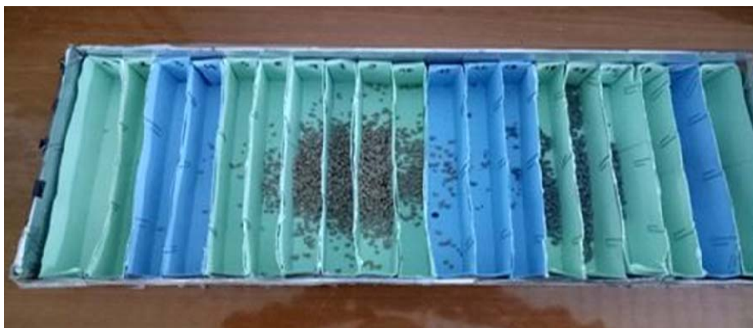
Figure 4.23: Résultats de séparation ABS/PVC obtenue par un séparateur à tapis convoyeur
