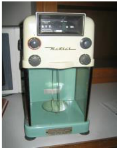
Fig. A1. 2. Balance E. METTLER Type H6T DigCap 160g avec une précision de 0,1mg [174].
