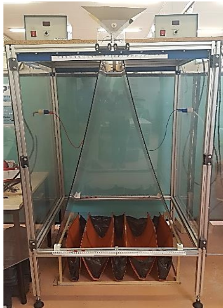
Figure IV.21. Séparateur à chute libre utilisé dans les expériences – IUT d'Angoulême.
