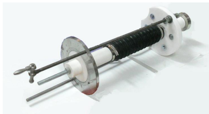
Figure II.12. Système d'ajustement manuel de la distance inter-électrodes.
