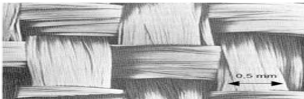
Fig. I. 5 Microstructure vue au MEB d'un tissu de mèches avant imprégnation avec la résine.
