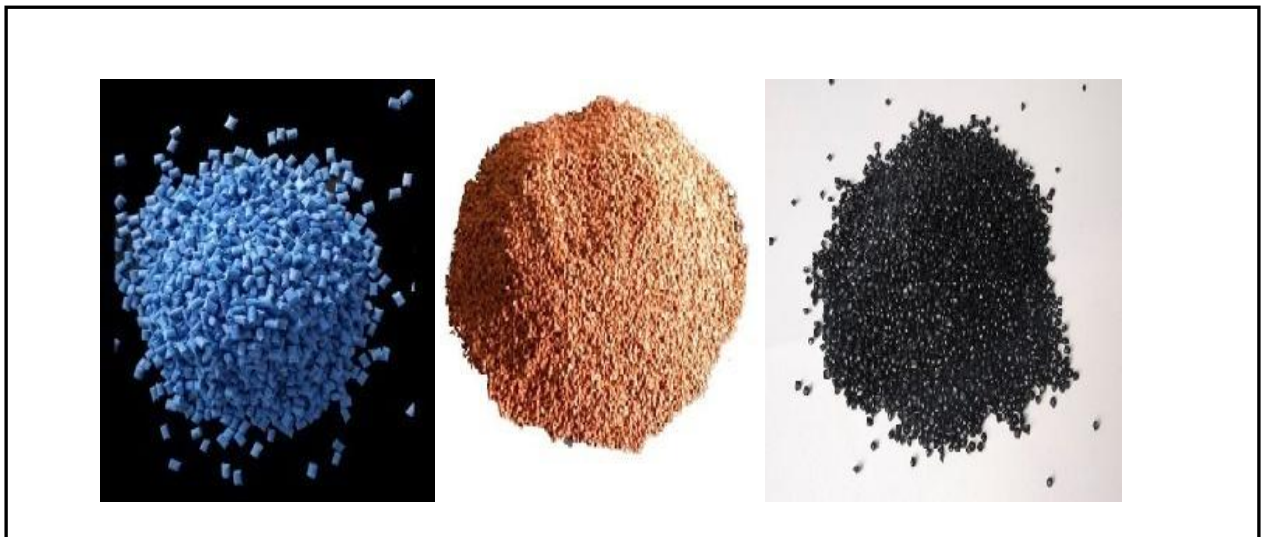
Figure II.10 : Aspect des granules du PA (a), de PP (b) et de PVC(c) appartenant à la classe granulométrique 2÷3 mm.
