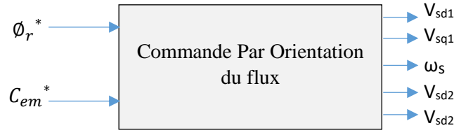
Fig.II.3.Schéma Bloc de la commande à flux orienté
