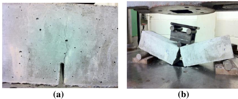
Figure IV.8: Essai du béton en flexion trois points : (a) la propagation de fissure ; et (b) à la fin de l'essai.
