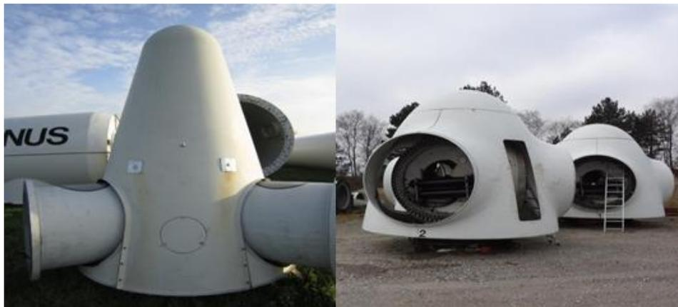
Fig.8 Moyeu de rotor : a) représente Moyeu de rotor AN Bonus MKIV 600 kW b) Moyeu de rotor GE 1.5 MW.
