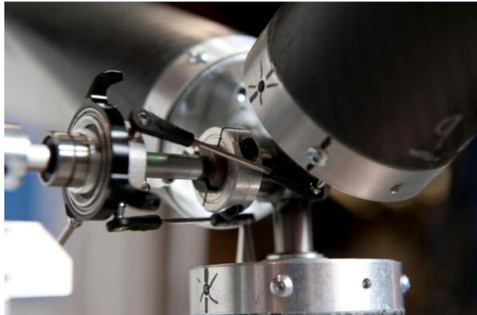
*Fig.9 Contrôle du calage des pales sur une maquette 1:50 d'éolienne offshore*
