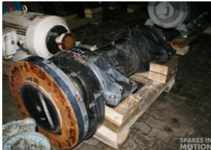
Fig.6 L'arbre principal de l'éolienne NTK 500
