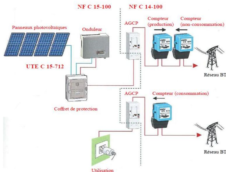
*Fig.9 Exemple d'une installations raccordées au réseau injection totale*
