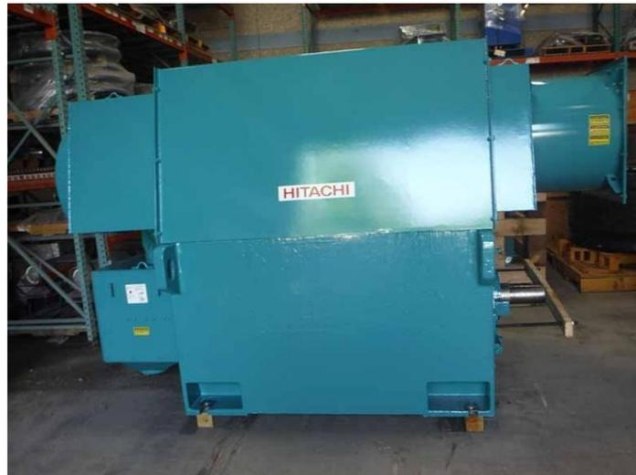
Fig.15 Hitachi 1,5 MW générateur pour éolienne GE 575V
