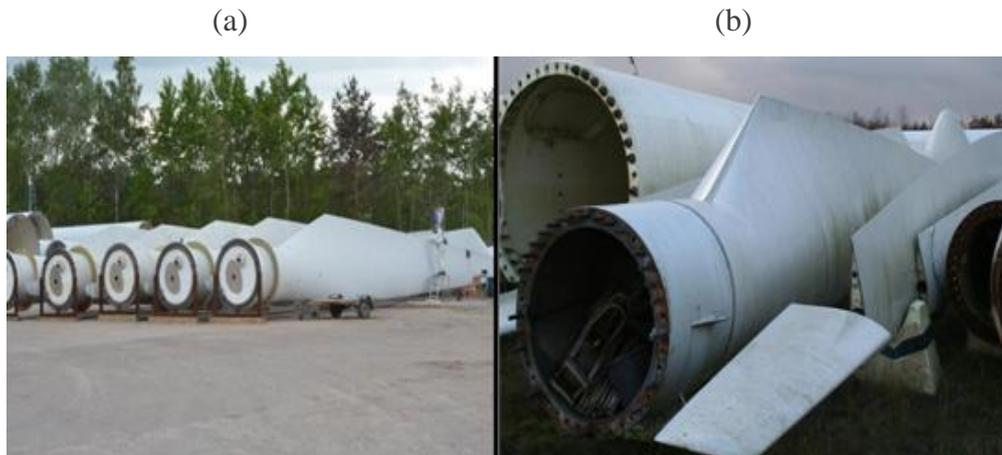
Fig.7 Les pales de rotor : a) pales d'une et Lames de Vestas V66 1.5MW b) pales Gamesa G52 utilisé au Park a Kaberten (Adrar)
