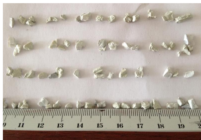
Figure II.4 : Aspect et dimension des granules de polystyrène à fort impact HIPS.
