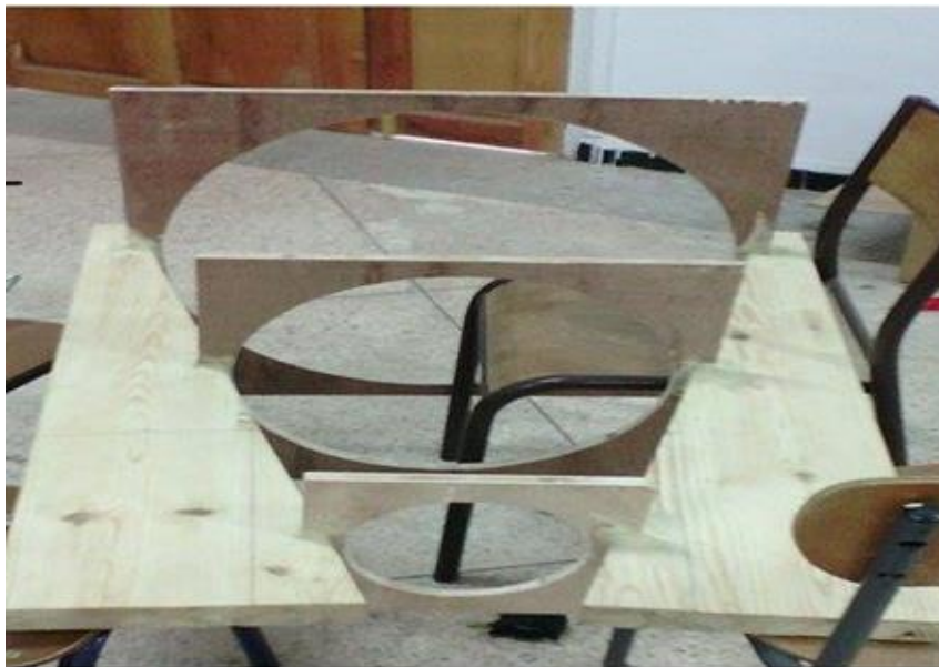
Figure IV.10 : Photo du dispositif montrant le support de la partie conique des électrodes.
