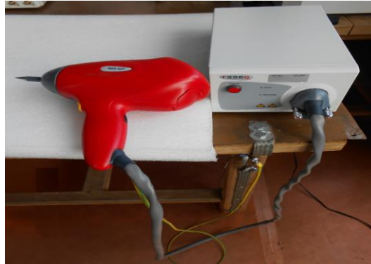
Figure III.17. Photographie du générateur DES utilisé dans le test.
