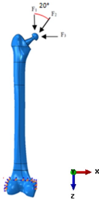
Figure V-3: Représentation schématique des conditions aux limites imposées à la structure analysée.
