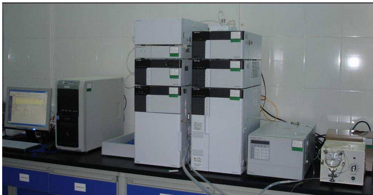
Figure 20 : Présentation de l'appareil d'HPLC, équipé avec un détecteur à barrettes de type diodes (Hewlett Packard, série 1500).
