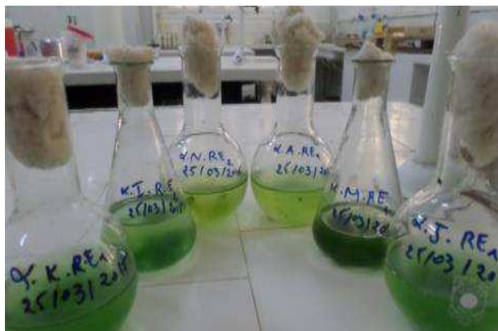
Figure 27 : La culture des cyanobactéries, isolées à partir de l'eau du lac SMB et du barrage Sarno, inoculées sur milieu de culture liquide BG11, incubées à une température de 25°C avec une intensité lumineuse de 2000 lumens.
