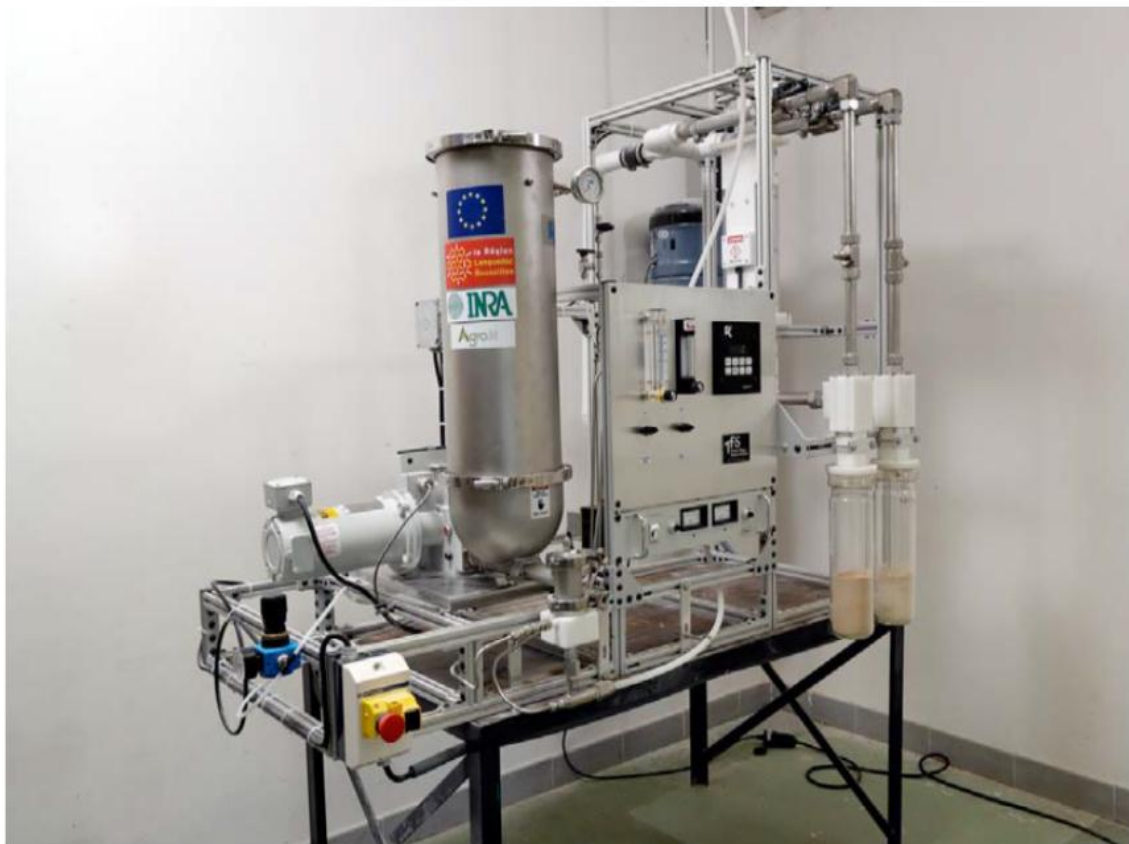
Figure I.24. Photographie d'un séparateur tribo-aéro-électrostatique (INRA).
