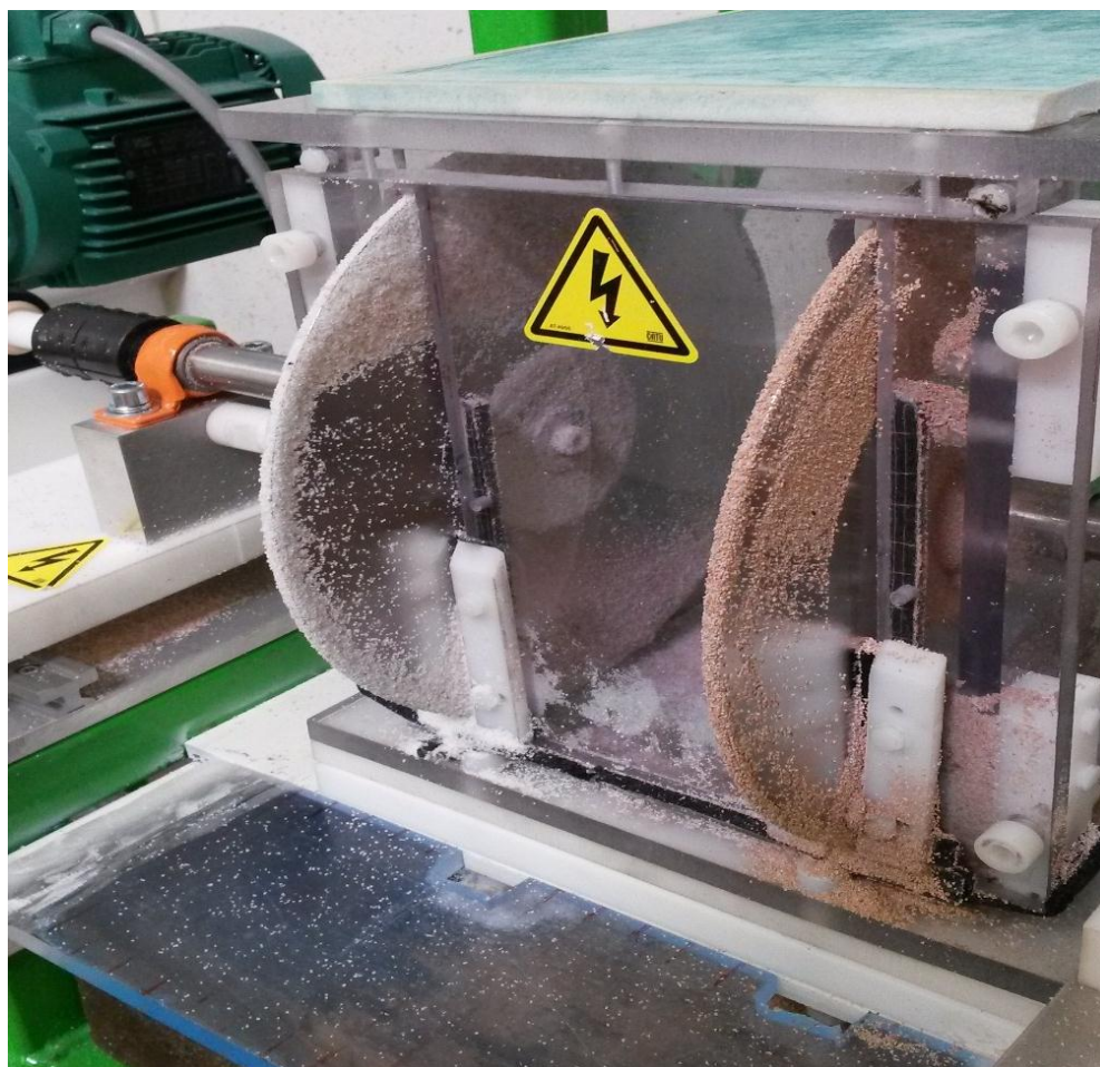
Figure IV.5. Collecte des particules isolantes dans le séparateur tribo-aéro-électrostatique à deux-électrodes-disques-tournante.
