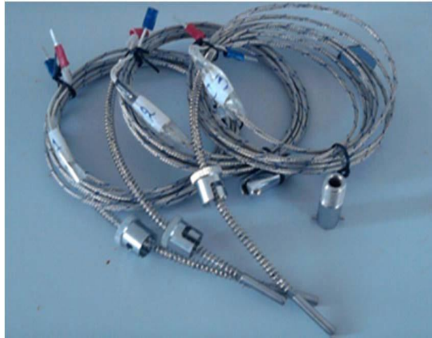
Figure II.15 : Thermocouples type K utilisés dans la cellule [69].
