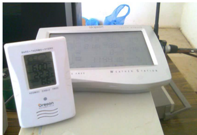
Figure II.16 : Dispositif de mesure de l'hygrométrie [69].
