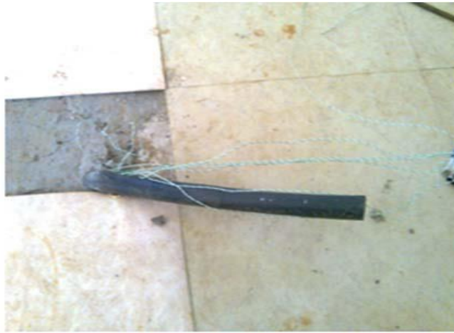
Figure 21 : Emplacement des thermocouples dans le circuit hydraulique [69].
