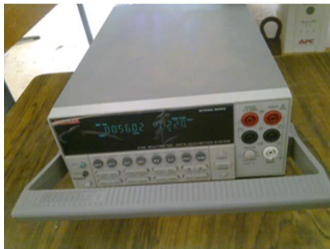
Figure II.18: Chaîne d'acquisition des données type KEITHELEY [69].
