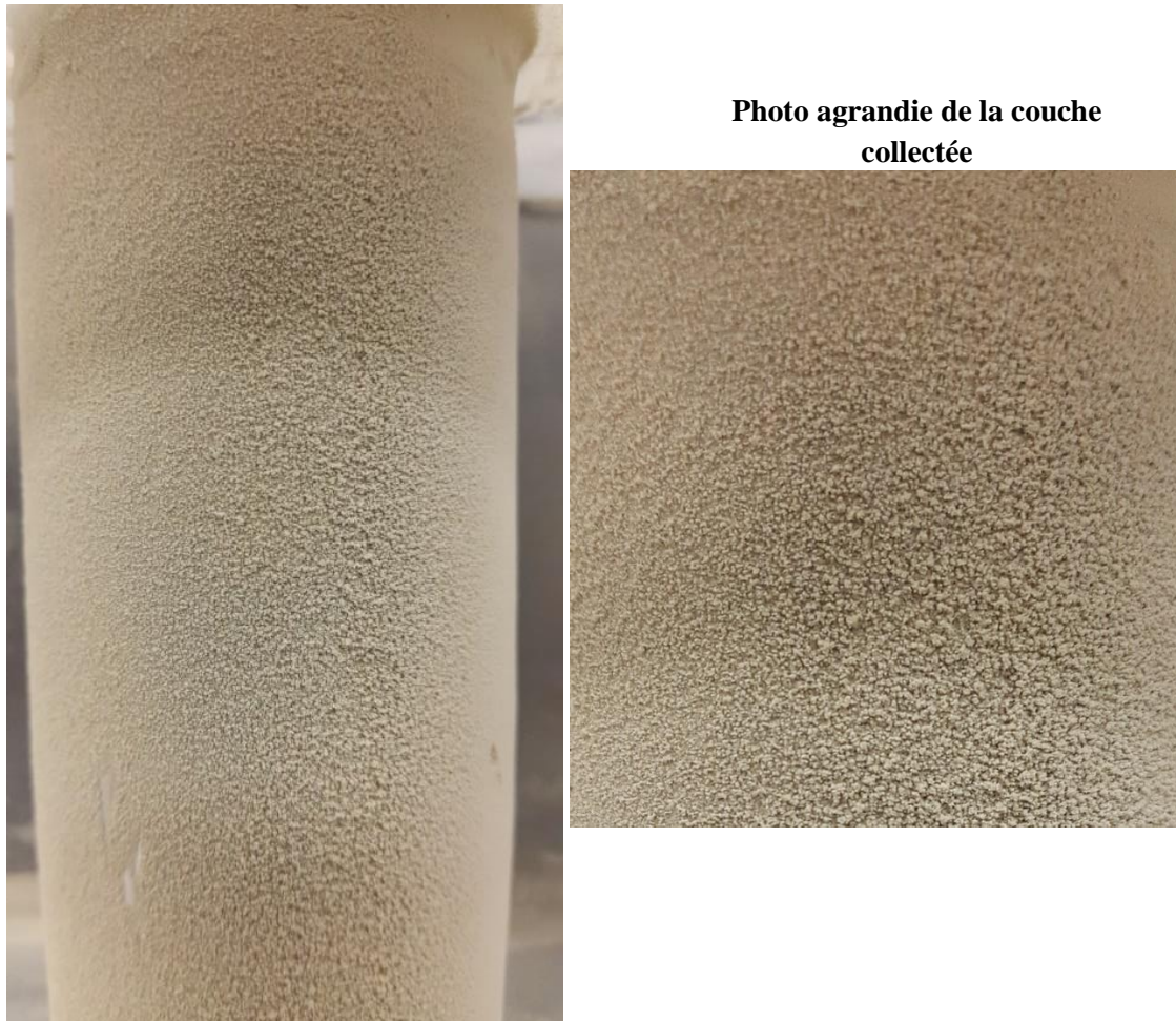
Figure. IV.19 : Photographie des particules collectées sur l'électrode de collecte. (Photo prise après 9 h de fonctionnement).
