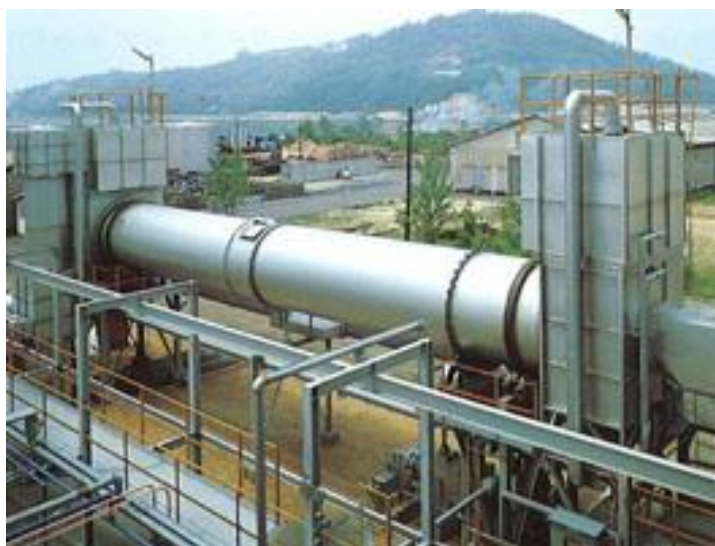
Figure.I.12 : Précipitateur électrostatique type tube rotatif (Rotary tube type Electrostatic precipitator-HITACHI).
