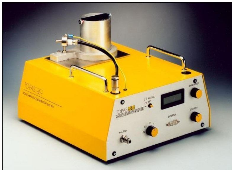
Figure.II.2. Photographie du disperseur de particules (Topas SAG, model 410).
