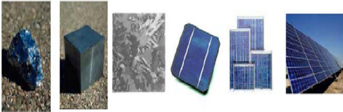
Fig.I. 10. Passage d'une cellule à un champ photovoltaïque [20].
