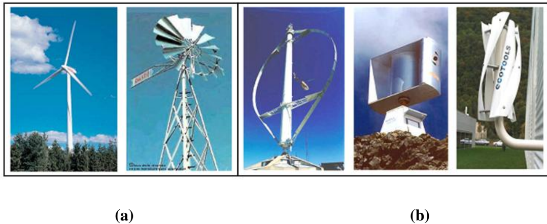
Figure 5. 11: Technologies d'éoliennes, (a) à axe horizontal et (b) à axe vertical.
