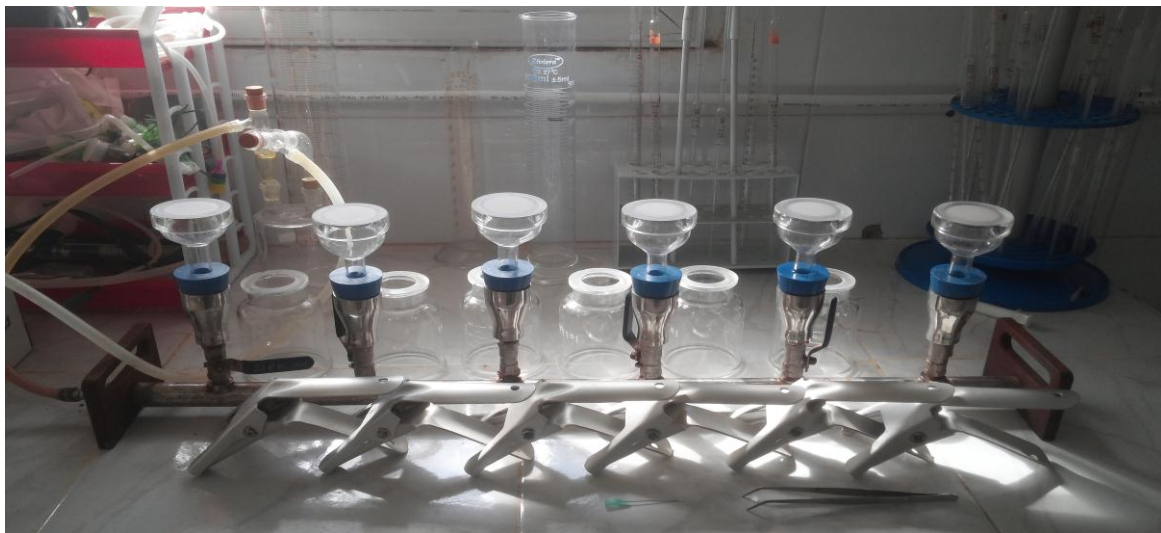
Figure N°35: Rampe de filtration six tête en inox (Doukani, 2016).
