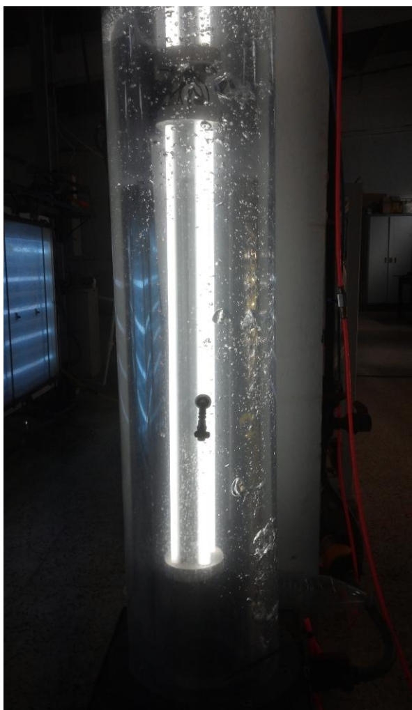
Figure N°41: Photobioéacteur Cyclindrique double tube(Doukani, 2016)
