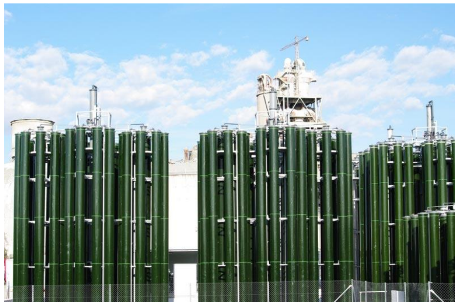
Figure N°25 : Photographie d'un photobioréacteur cylindrique (BFS, 2008)
