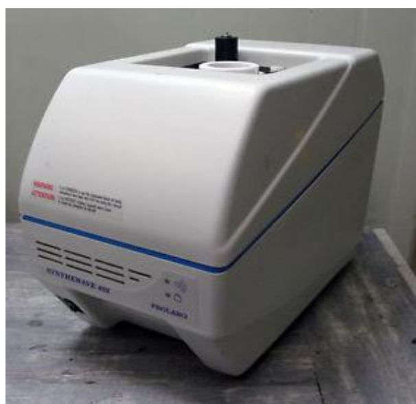
Figure II-1. Réacteur micro-onde type Synthwave 402
