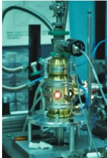
Figure (1.17) Schéma de l'appareillage d'ablation laser.
