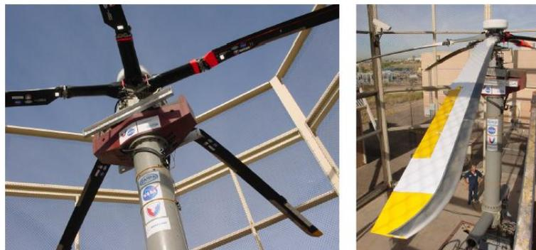
Figure I.6. Contrôle actif des vibrations d'une pale d'hélicoptère.
