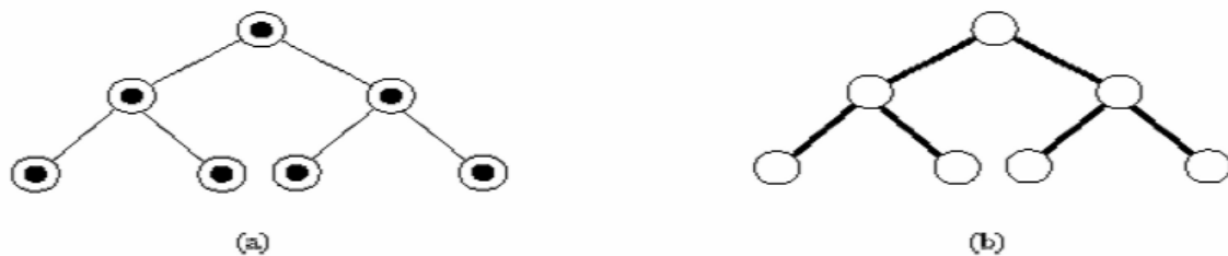
Figure.4.10. Pistes de phéromone peuvent être associées (a) aux composants (b) ou aux connexions
