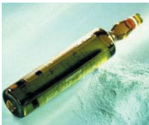
Figure II.5 : Composition du liquide : Monomère (méthylméthacrylate, butyl méthacrylate). Activateur (DmpT : N, N-dimethyl-p-toluidine)
