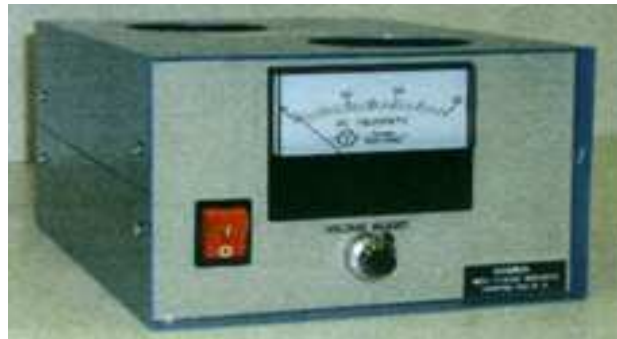
Figure 2.5. Alimentation haute tension modèle ES20P-5 (+20 kV ; 5 W), fabriquée par la société Gamma High Voltage Research Inc, FL, USA
