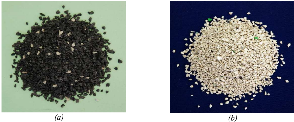
Figure 2.7 : Aspect des granules d'ABS (a) et de HIPS (b) appartenant à la classe granulométrique 1÷2 mm.
