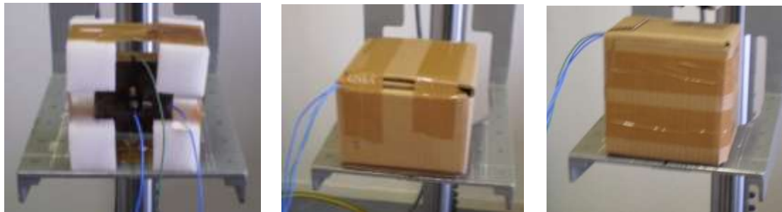
Figure 59 : Les trois types d'essais de choc par chute libre.
