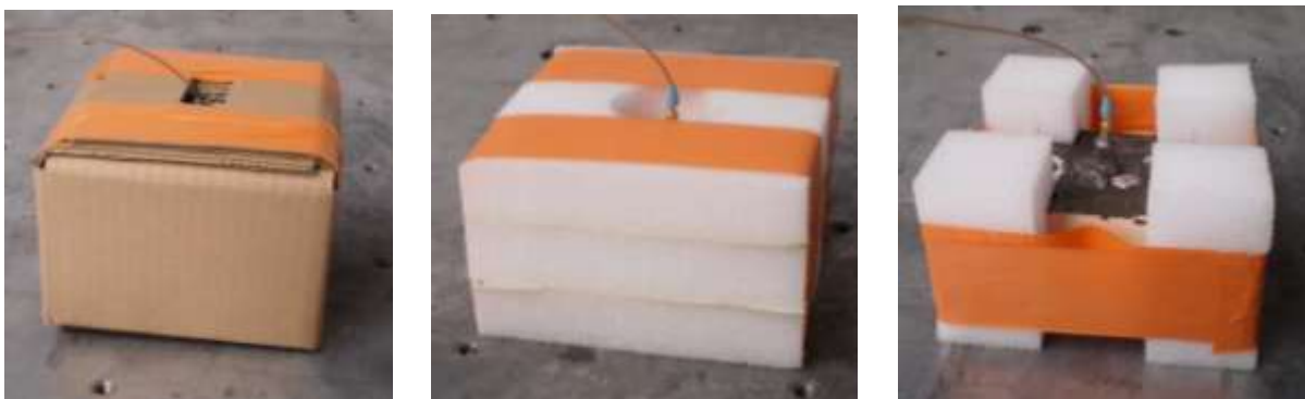
Figure 64 : Les différentes configurations d'emballage testées en vibrations aléatoires.
