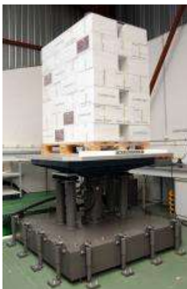
Figure 66 : Table vibrante hydraulique LANSMONT.
