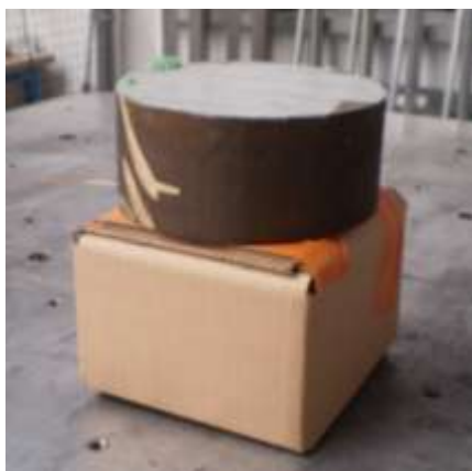
Figure 65 : Emballage étudié avec la masse au dessus simulant un empilement d’emballage.
