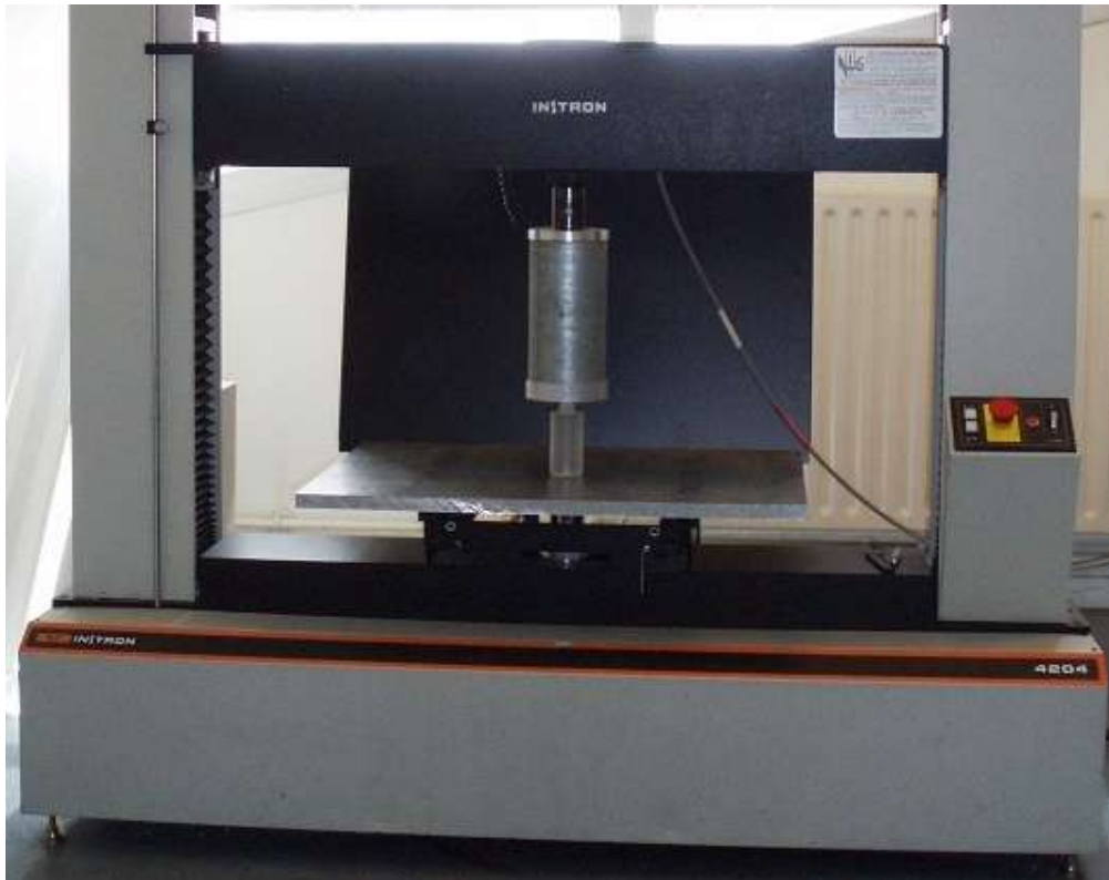
Figure 51 : Machine de tests mécaniques INSTRON 4204 avec le montage en compression.
