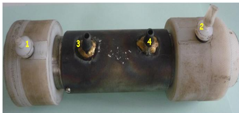
Figure 5. 36 : Générateur d'ozone avec circuit de refroidissement.
