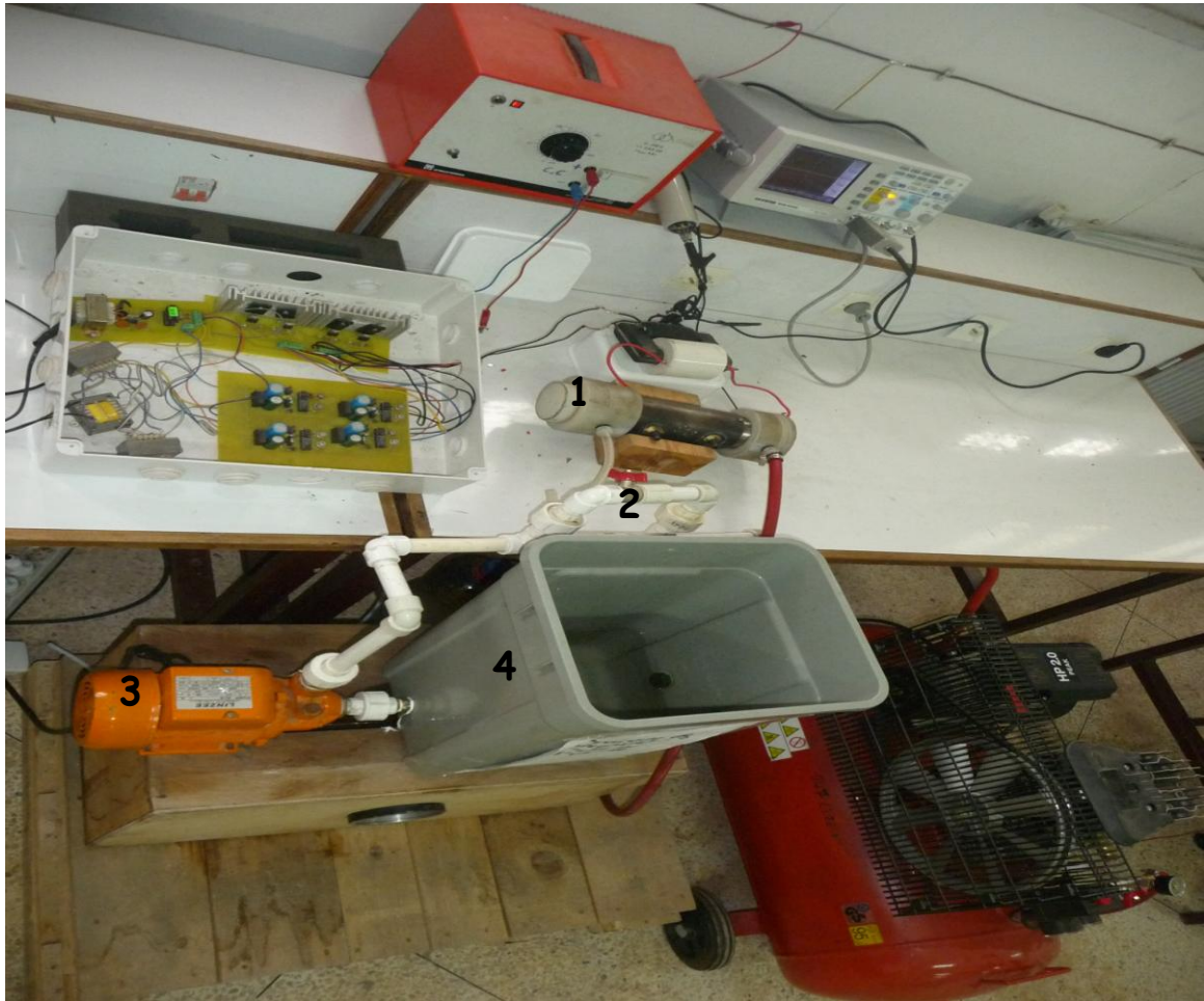
Figure 5. 34 : Photo du montage pour la purification d'eau. 1- Générateur d'ozone, 2- Système venturi, 3- Pompe à eau, 4- Réservoir d'eau.
