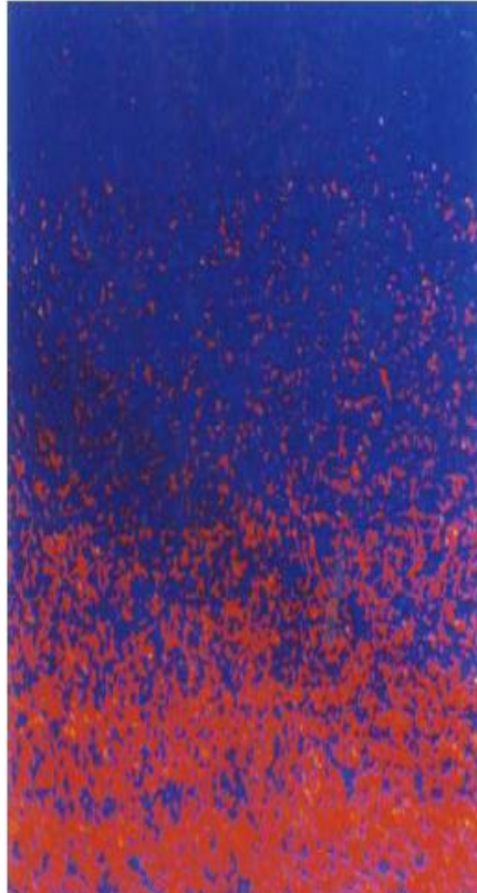
Figure II.1 : Variation de la fraction volumique des matériaux constitutifs dans la direction de l'épaisseur dans un matériau à gradient de propriétés [18].
