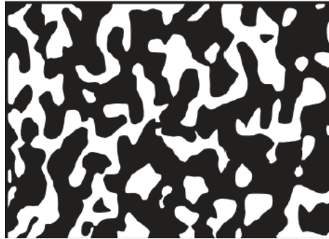
Figure I.6: Matériau FGM à deux phases avec microstructure squelettique
