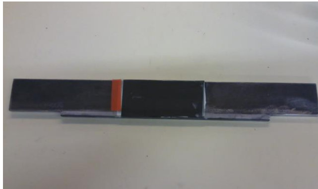
Figure 4-33 : Éprouvette instrumentée par une grille.
