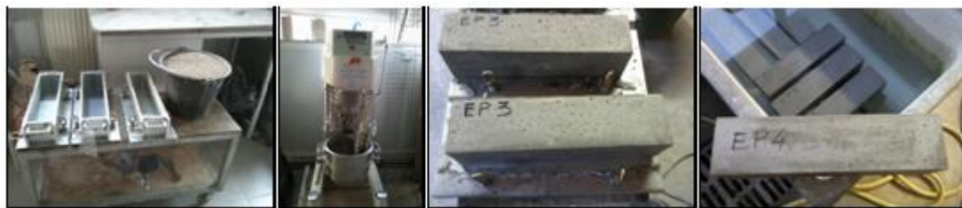
Figure 4-4 : Le procédé de confection des éprouvettes : (a) moules, (b) malaxeur, (c), démoulage et (d) murissement.
