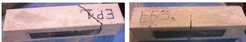
Figure 4-14 : Rupture à l'effort tranchant des éprouvettes renforcées.
