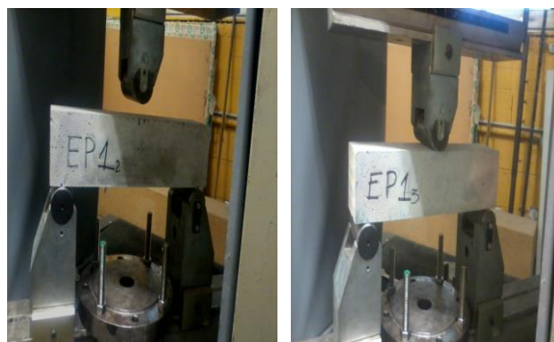
Figure 4-16 : Mode de rupture des éprouvettes renforcées avec des sections différentes de FRP.
