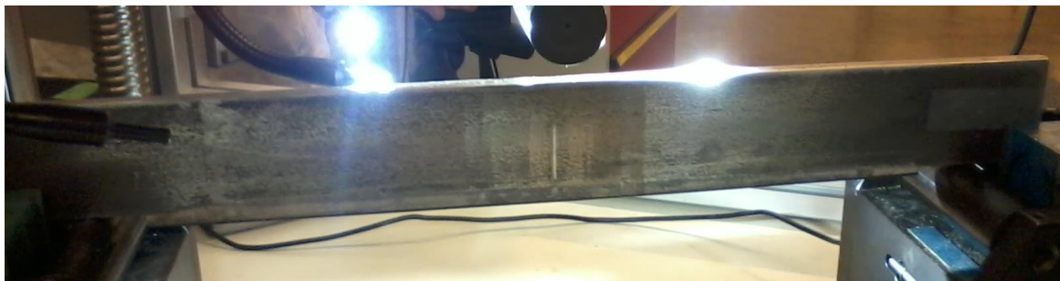
Figure 4-30 : Eprouvette fissurée de 20 mm.
