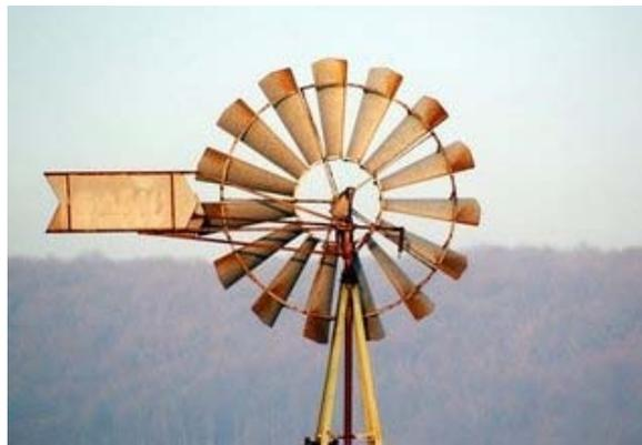
Figure II.1 : Eolienne de pompage d'eau ancienne.
