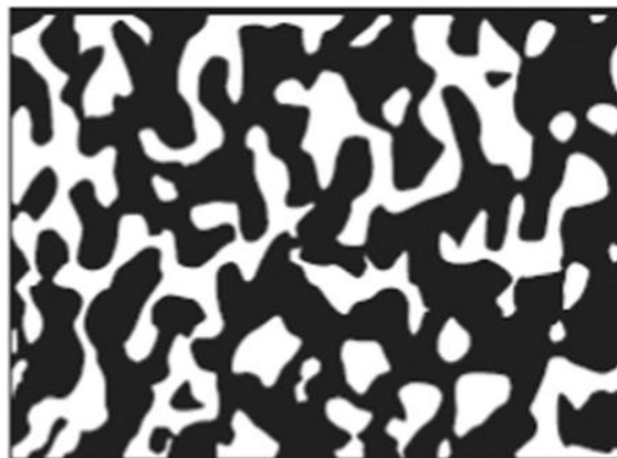
Figure II.2 : Matériau à deux phases avec microstructure du squelette
