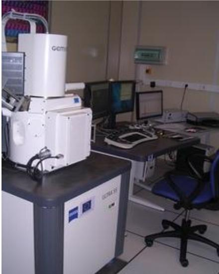
**Figure III.2323 :** Microscope Electronique à Balayage ULTRA 55.
