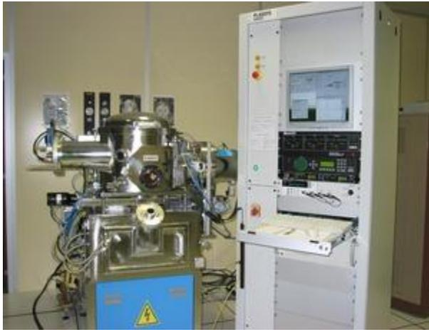
**Figure III.2828 :** Evaporateur PLASSYS MEB 550S.
