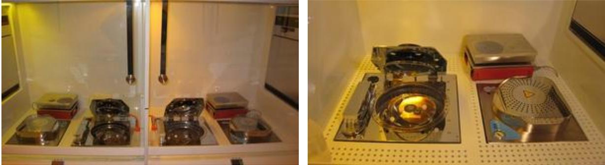
**Figure III.1818 :** Equipements d'enduction intégrés dans les hottes à flux laminaires.
