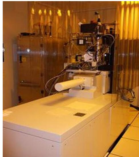
**Figure III.2020** : Nanomasqueur VISTEC EBPG 5000Plus ES.
