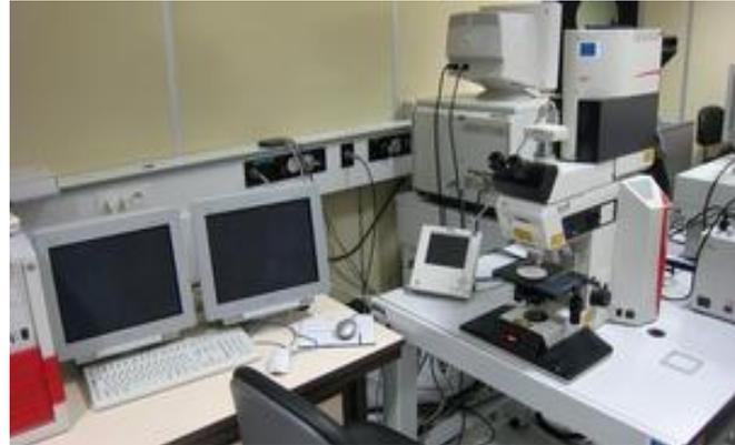
**Figure III.2222 :** Microscope optique Leica DM RXE.
