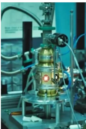
Figure I.12: Schéma de l'appareillage d'ablation laser.
