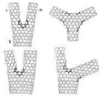
Figure I.23: Défauts pentagonaux et heptagonaux se traduisant par des jonctions.
