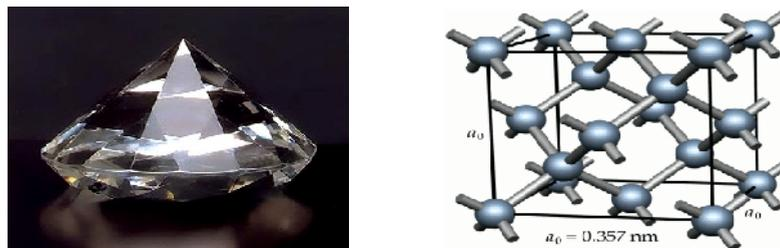
Figure I.2: Structure du diamant.
