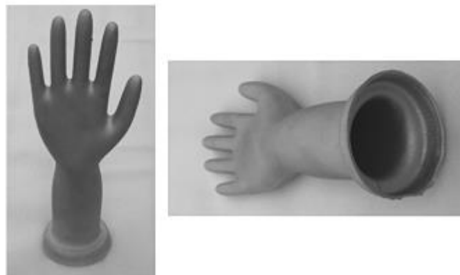
Figure I.16 : Moule de gants réalisé en Ti_3SiC_2
