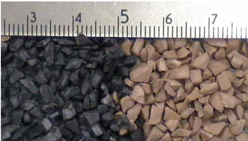
Figure 4.23 : Photo des granules d'ABS (marron) et de HIPS (noir)
