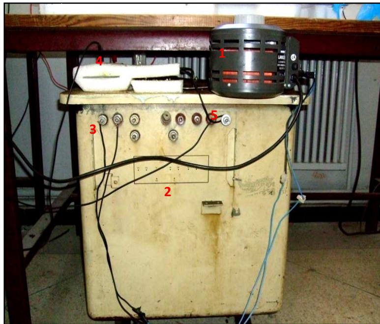
Fig.3.4. Alimentation haute tension DC utilisée
