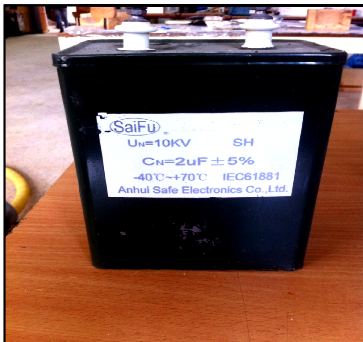
Fig.3.6. Condensateurs de stockage
