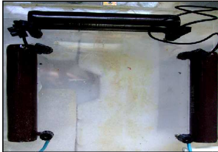
Fig.3.5. Circuit de résistance pour limiter le courant
