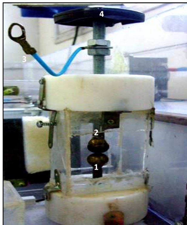
Fig.3.8. Eclateur pour le déchargement des condensateurs
