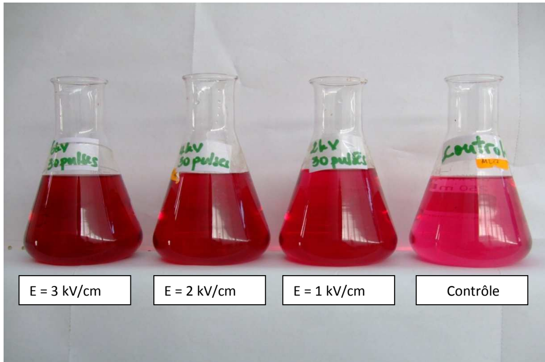
Fig.4.16. Différence de la coloration obtenue en fonction du champ électrique
