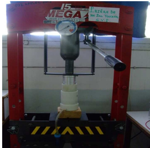
Fig.4.5. Presse Hydraulique utilisés pour l'extraction
