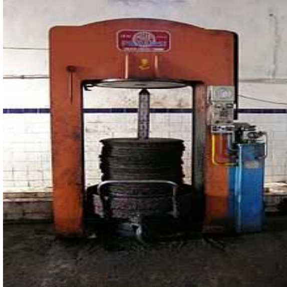
Fig. 4.1. Extraction en utilisant une pression hydraulique
