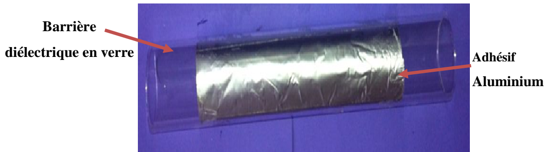
Figure 3.1. Photographie d'une électrode métallique interne en adhésif aluminium à l'intérieur de la barrière diélectrique en verre.
