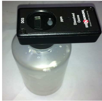
Figure 3.7. Photographie d'un Analyseur d'ozone utilisé pour mesurer la concentration d'ozone dissous dans l'eau.
