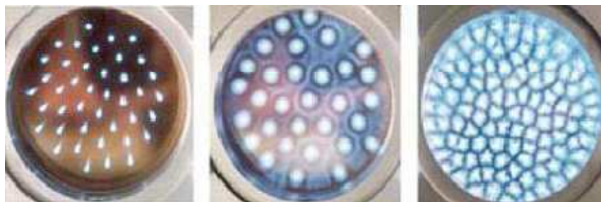
Figure 1.7. Quelques modèles de filament (micro-décharges) d'une DBD
