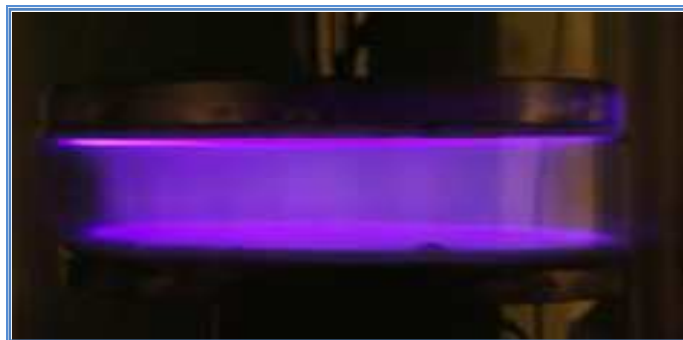
Figure 1.9. Photo de la décharge lumineuse générée entre deux électrodes planes recouvertes d'un diélectrique
