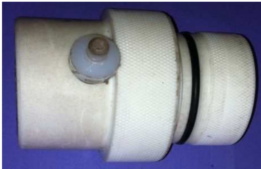
Figure 3.2. Photographie de bouchon de centrage en téflon assurant une distance inter-électrode homogène.
