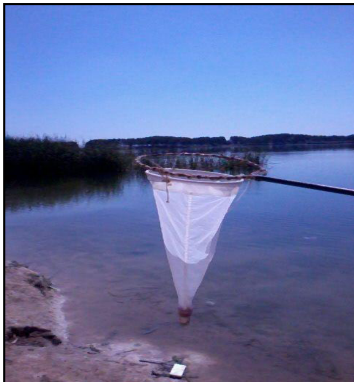
Fig. 29 : Filet à plancton de 55 \mu\text{m} utilisé dans les prélèvements.
