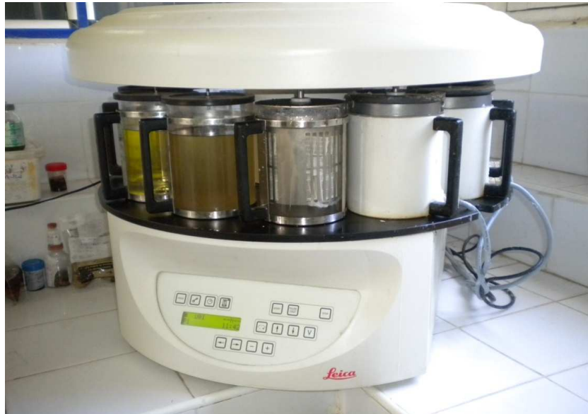
Figure n°31 : Automate de déshydratation (ClichéKechar, 2013)
