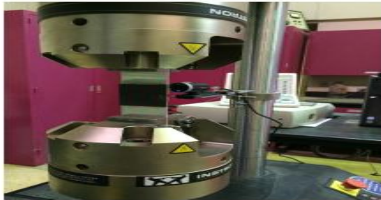
Figure 4-6 : montage de l'éprouvette réparée sur la machine de fatigue
