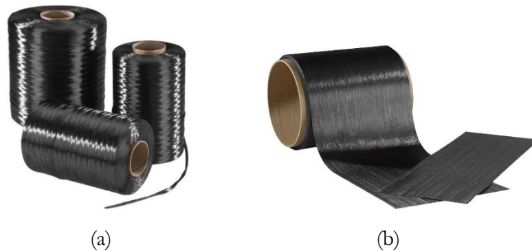
Figure 2 : (a) Bobines ou rovings de carbone, (b) Pli unidirectionnel de fibres de carbone préimprégné de résine époxy [1].
