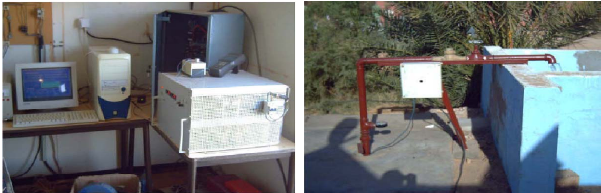
Figure III.14 : Vue de la partie électrique (à gauche) et hydraulique (à droite) du banc d'essai en fonctionnement
