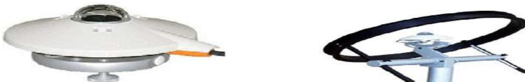
Figure I.7 : Pyranomètre (à gauche), Solarimètre (à droite)
