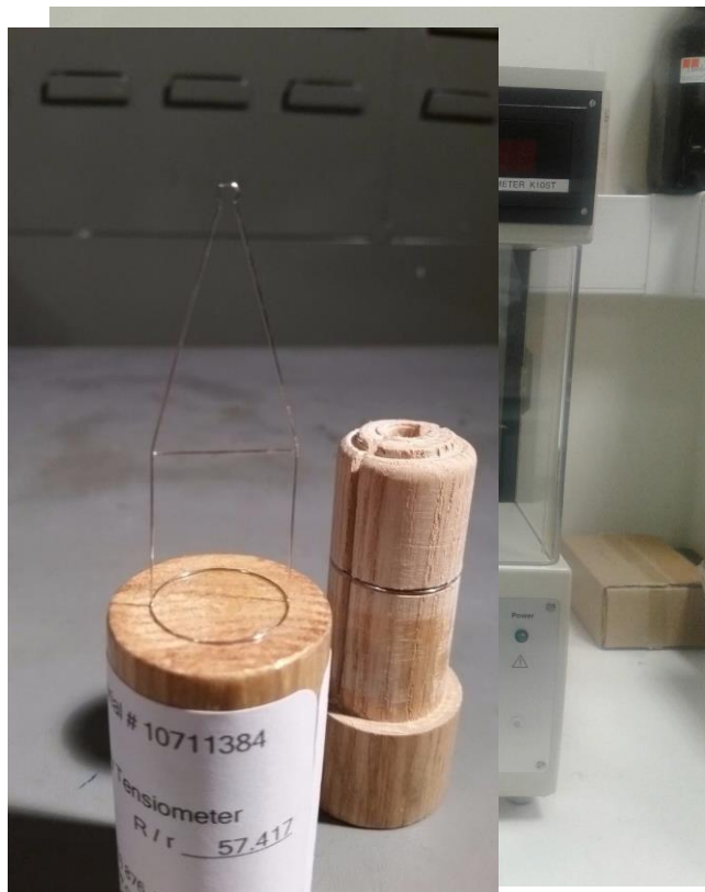
Figure 22 : Présentation d'un tensiomètre digital K10ST – KRUSS, et l'anneau en Platinum-Iridium.
