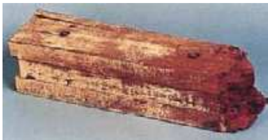
Figure II.11. Dicorynia guianensis attaqué par une pourriture molle
