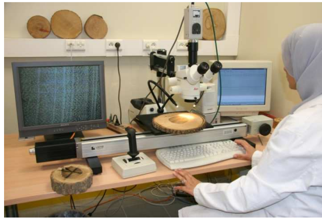
Figure III.11. Comptage du nombre de cerne et leur largeur à l'aide de l'appareil Lintab
