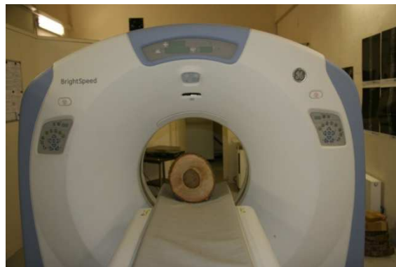
Figure III.6. Numérisation des billons à l'aide d'un scanner médical 3D adapté au matériau bois
