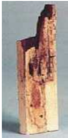
Figure II.9. Dicorynia guianensis attaqué par une pourriture brune
