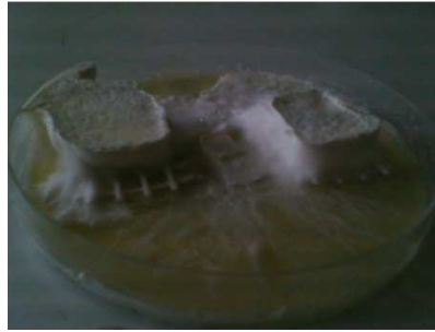
Figure III.33. Épreuves d'aubier non séchées déposées sur grille avec la souche Poria placenta après 16 semaines d'incubation
