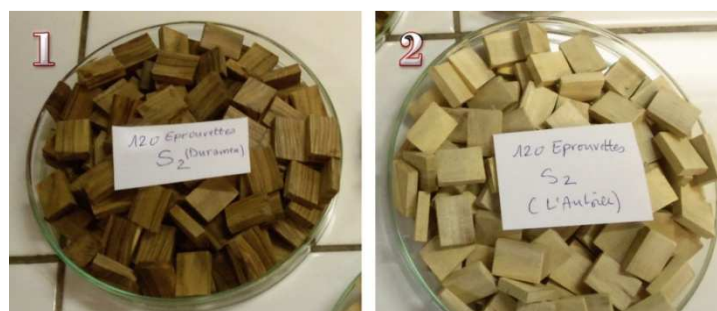
Figure III.31. Eprouvettes de duramen (1) et d'aubier (2) du pistachier destinées aux tests de durabilité naturelle
