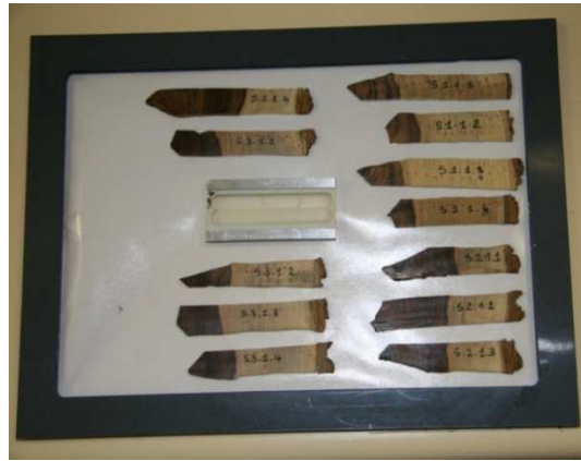
Figure III.22. Disposition des éprouvettes du pistachier de l'Atlas et de la cale sur le support
