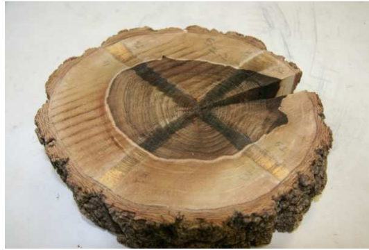
Figure III.10. Rondelle n°2 surfacée selon les quatre rayons tracés
