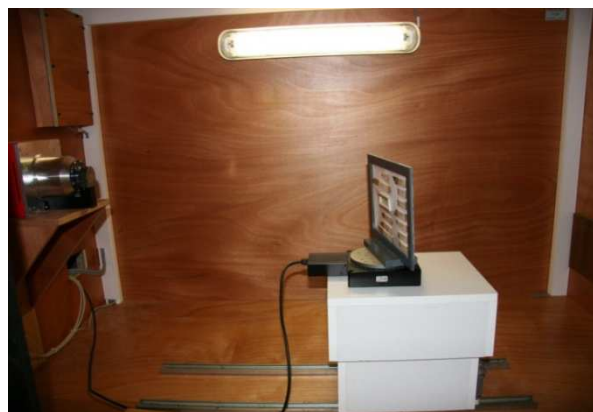
Figure III.23. Disposition des échantillons dans l'appareil de radiographie
