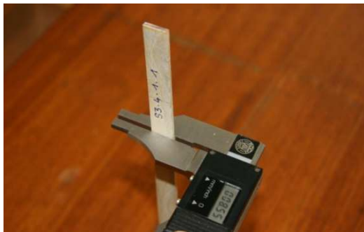
Figure III.30. Positionnement d'une éprouvette entre les faces de mesure d'un pied à coulisse
