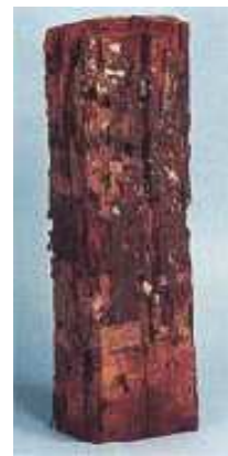
Figure II.10. Dicorynia guianensis attaqué par une pourriture blanche
