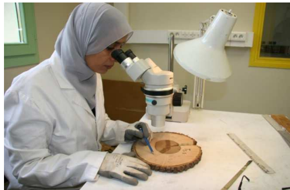
Figure III.9. Comptage manuel des cernes d'une rondelle de souche du pistachier de l'Atlas à la loupe binoculaire
