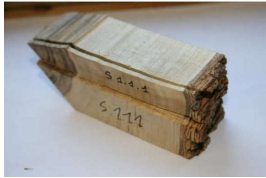
Figure III.15. Découpe d'une barrette du pistachier de l'Atlas dans un barreau
