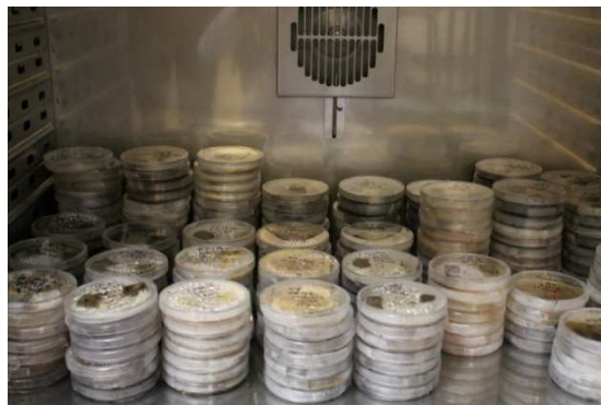
Figure III.32. Les éprouvettes du pistachier de l'Atlas après 16 semaines d'incubation dans une enceinte hygro et thermorégulée à 22^{\circ}\text{C} et à 70% d'humidité relative
