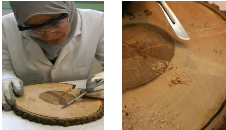
Figure III.8. Surfaçage d'une face d'une rondelle de souche à l'aide d'un scalpel
