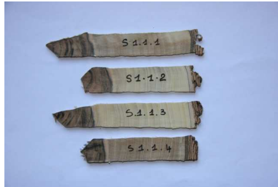
Figure III.21. Barrettes du pistachier de l'Atlas destinées à la microdensitométrie
