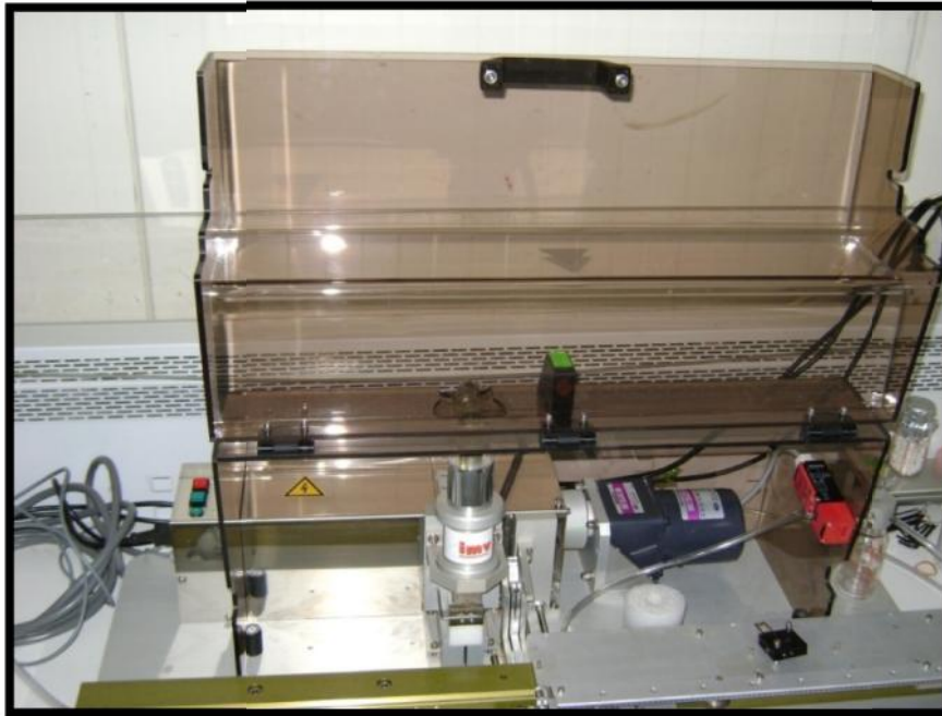
Figure 15 MRS ou machine de remplissage et de soudure.
