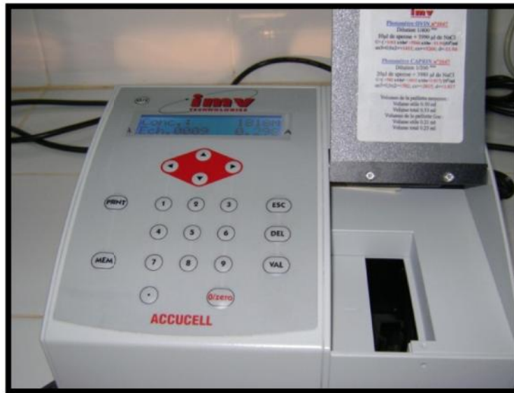
Figure 14 Spectrophotomètre adapté au calcul de la concentration de la semence des ovins et des caprins. Photo prise au centre d'IA de Belhandjir.
