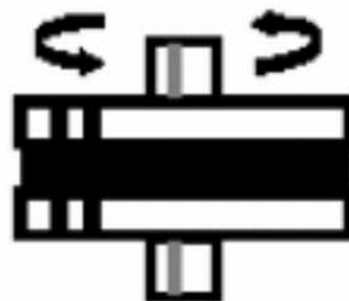
Figure 2.6 : Principe d'un rhéomètre rotatif plan-plan [43]
