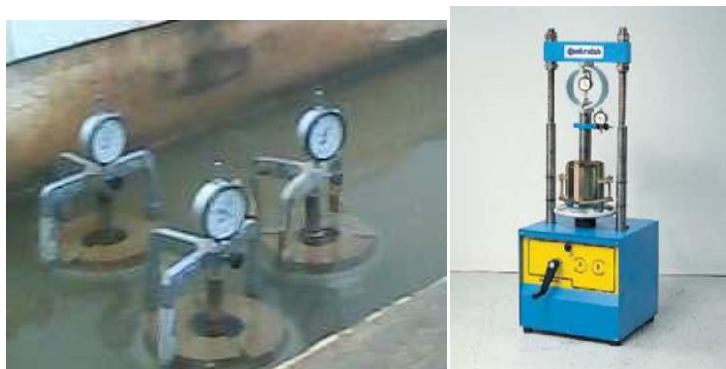
Photo VI.7: essai CBR et CBR imbibé.
