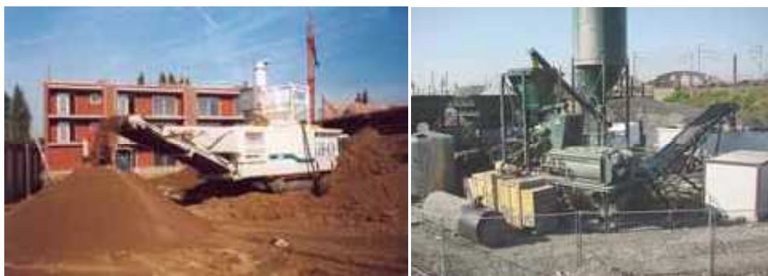
Photo III.6 :A) installations mobiles (malaxeur intégré) B) installations constituées d'éléments séparés [Abdo, 2009]
