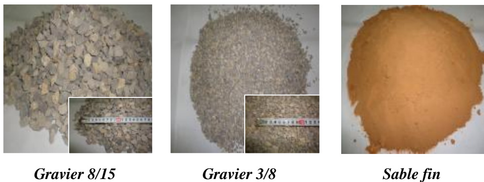
Figure IV.1 : Les granulats utilisés
