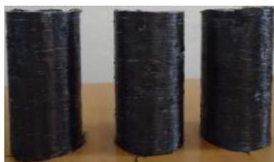
Spécimens réparés par tissu de fibre de carbone
