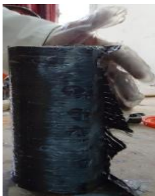
Positionnement de tissu de fibre de carbone
