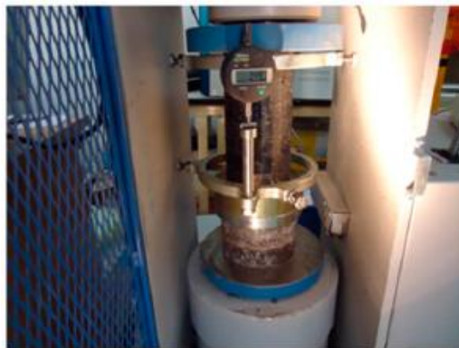
Figure V.21 : Installation d'essai de compression axiale.
