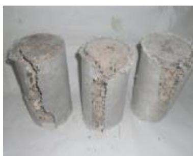
Figure IV.26 : Mode de rupture des spécimens de béton réparé par fibre de verre
