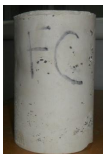
Figure V.16 : Eprouvtes confinée et protégée par plâtre
