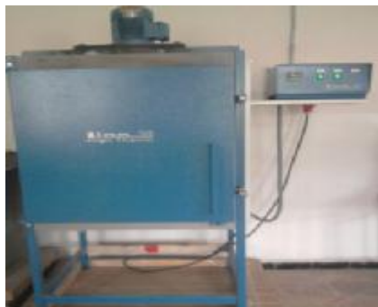
Figure IV.8: Four utilisé «linn High Therm» de température maximale 850°C
