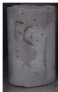
Figure V.17 : Eprouvtes confinée et protégé par mortier
