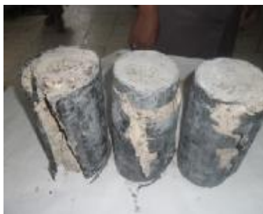
Figure IV.27 : Mode de rupture des spécimens de béton réparé par fibre de carbone
