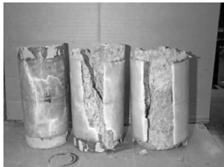
Figure.II.13 : Modes de rupture d'un béton renforcé par un FRP à base de fibres de verre et de résine époxy soumis à une charge de compression [42].
