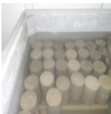
Figure IV.6 : Cure des éprouvettes pendant 28j
