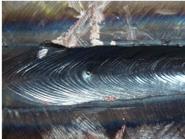
Figure 7 : cordon de soudure à arc submergé avec inclusion apparente
