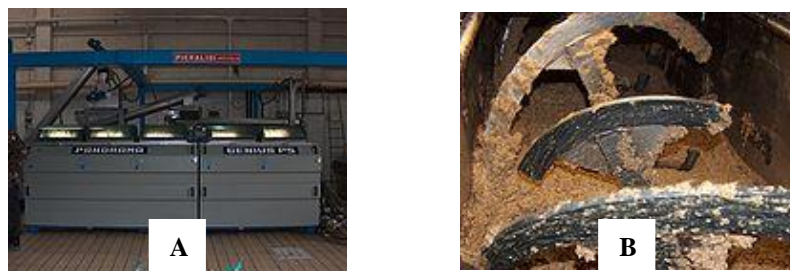
Figure 04 : Processus de malaxage des olives. A : Installation de bacs de malaxage en parallèle ; B : Pâte d'huile en mélange à l'intérieur d'un malaxeur (COI, 2015).
